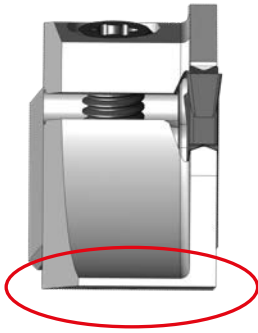
Sümilasyon analizi Ölçülen bükülme: 0.044 mm
